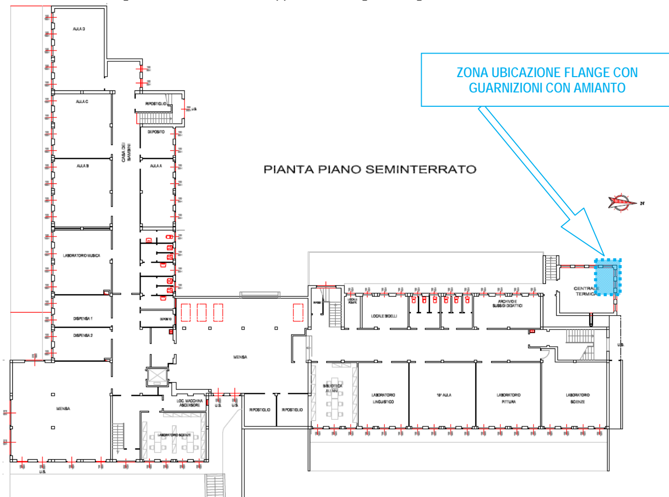
Figura 30: Ubicazione accoppiamenti flangiate con guarnizioni con amianto
