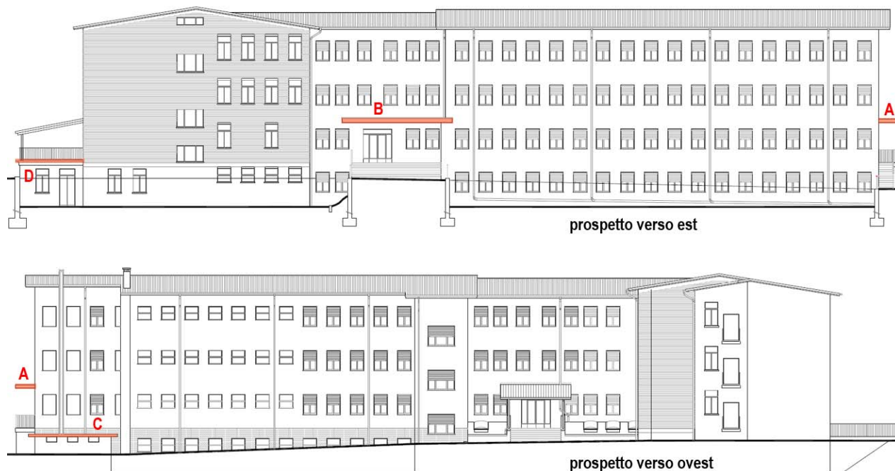
Figura 25: Localizzazione guaine bituminose con amianto
