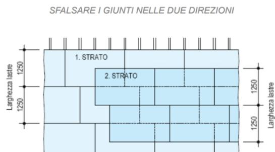
La corretta posa in opera delle pareti interne di separazione tra ambienti, ponendo attenzione ad effettuare un corretto disaccoppiamento delle strutture, garantirà non solo la minimizzazione della trasmissione del rumore per via aerea tra ambienti adiacenti, ma anche la riduzione di eventuali trasmissioni laterali del rumore di calpestio.
