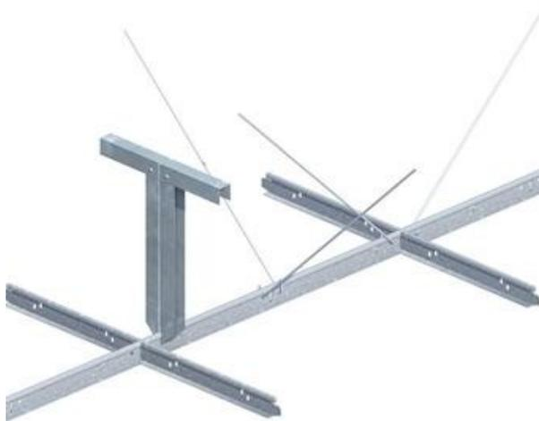
Ogni collegamento dovrà avere complessivamente una resistenza superiore a 0,04 kN, con adeguato margine di sicurezza. Al fine di consentire gli spostamenti laterali dovrà essere presente uno spazio libero di almeno 1 cm su tutti i bordi del controsoffitto alle interfacce con gli elementi verticali. Gli elementi dovranno essere dotati di dispositivi antiganciamento in caso di azioni orizzontali/verticali.
