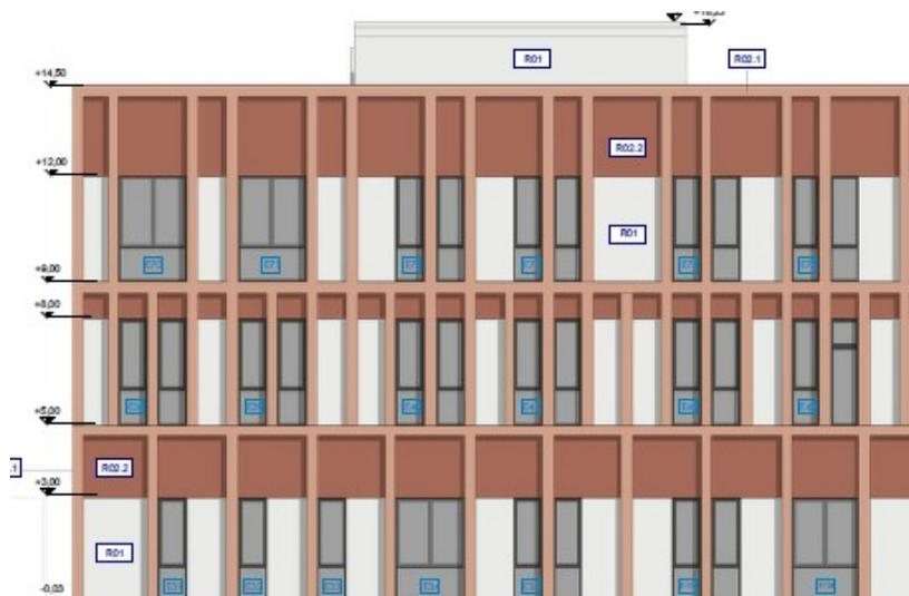
Per il sostegno di montanti e traversi emergenti di rivestimento si prevede la realizzazione di una sottostruttura in carpenteria metallica, costituita da montanti e traversi in acciaio S275 tubolari rettangolari 120x4mm.
