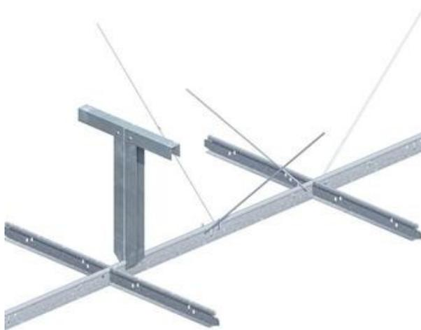
Ogni collegamento dovrà avere complessivamente una resistenza superiore a 0,07 kN, con adeguato margine di sicurezza. Al fine di consentire gli spostamenti laterali dovrà essere presente uno spazio libero di almeno 1 cm su tutti i bordi del controsoffitto alle interfacce con gli elementi verticali. Gli elementi dovranno essere dotati di dispositivi antisganciamento in caso di azioni orizzontali/verticali.
