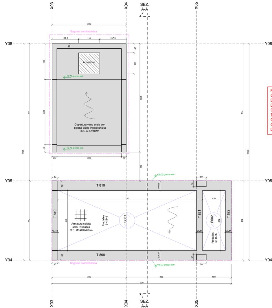
**PRIMA DEL GETTO DI QUALSIASI MEMBRATURA E DEL COMPLETAMENTO DELLA CASSERATURA OCCORRE PREDISPORRE I PASSAGGI DELLE CANALIZZAZIONI, DA CONCORDARE CON IL DIRETTORE DEI LAVORI.**
